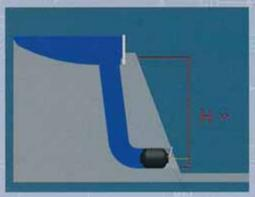
I palloni sono rinforzati con tessile in kevlar. I rinforzi particolari montati nelle posizioni più esposte (fondo e testa del pallone) permettono al pallone di lavorare a pressioni elevate.
