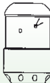
Ugelli Rotanti in acciaio inox con fori contrapposti 90° e 45° a getto anteriore
