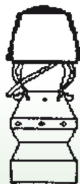
Ugelli a elica con testa in Widia
